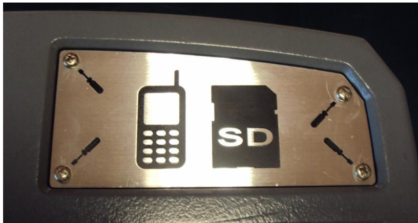
Figure 16 : Plaque de protection de la carte SD
