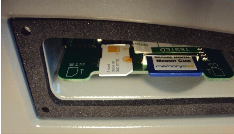
Figure 18 : Carte SIM mise en place
